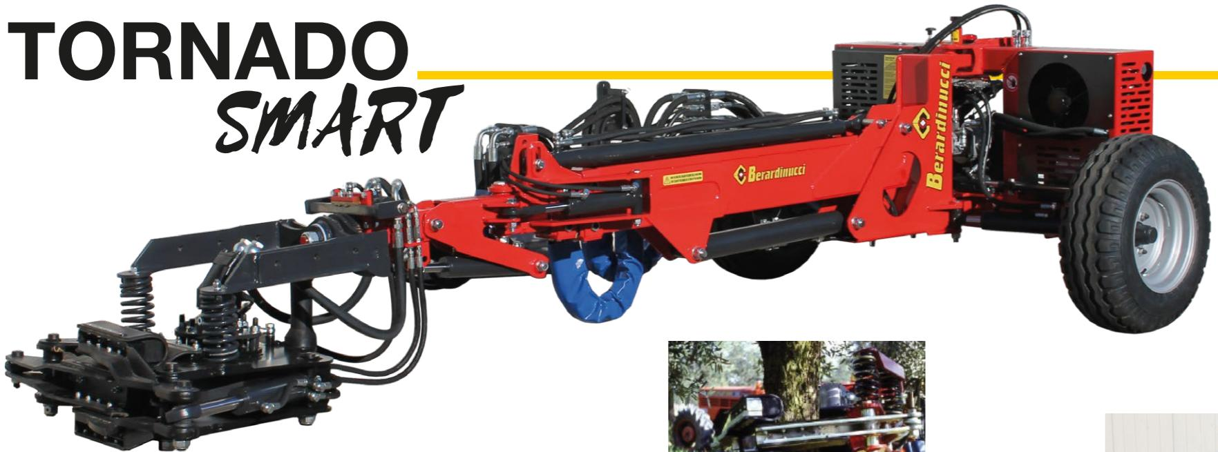
Il modello **TORNADO SMART** è una macchina vibrante di nuova concezione con caratteristiche innovative, caratterizzata da un telaio di **dimensioni contenute** che gli permette di avere una linea agile e snella. **Progettata** e realizzata specificatamente per la **raccolta delle olive**, la sua eccezionale **versatilità di utilizzo** la rende molto efficiente anche per la raccolta di **noci, pistacchi, mandorle, ciliegie, prugne** e tanto altro.
